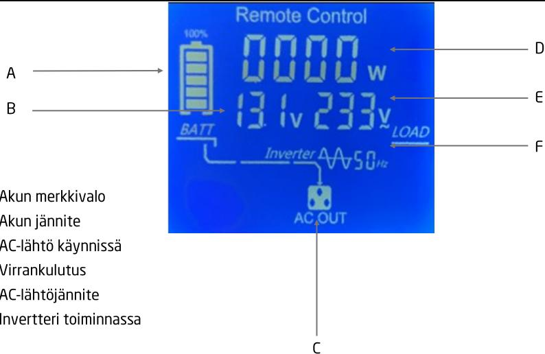
KAUKOSÄÄTIMEN NÄYTTÖ SIIRTOKYTKENTÄTILA (1000W / 1500W /2000W /3000W)
